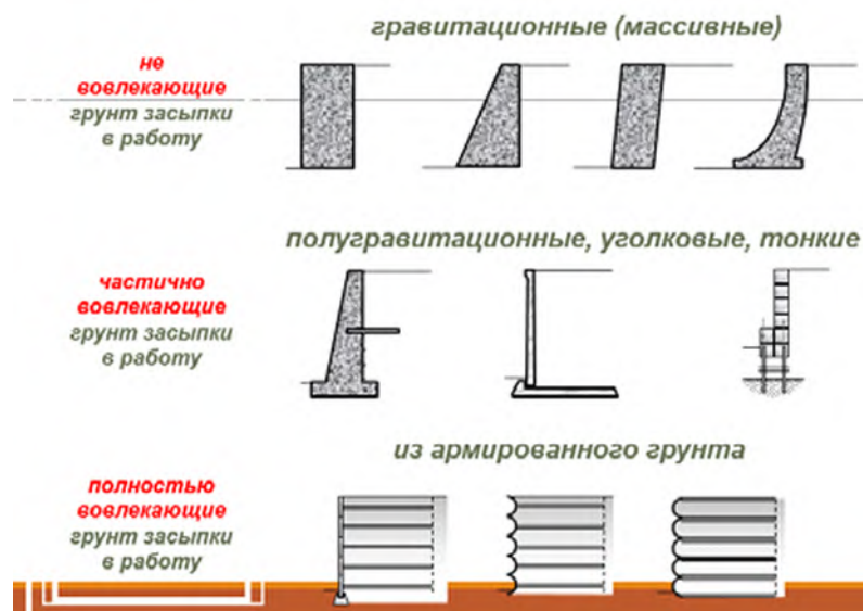
Рис. 7. Классификация подпорных стен по степени вовлечения грунта в дело по обеспечению устойчивости
