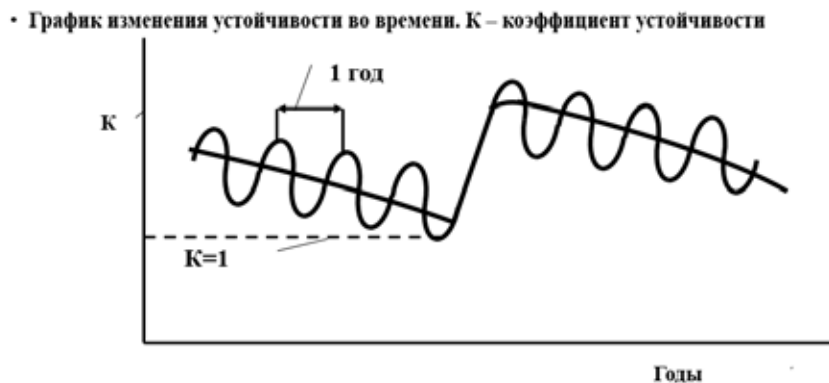
Рис. 1. Схема изменения устойчивости грунтового сооружения во времени
