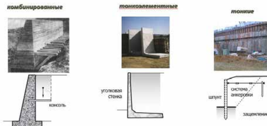
Рис.10. Полумассивные, тонкоэлементные и тонкие подпорные стены
